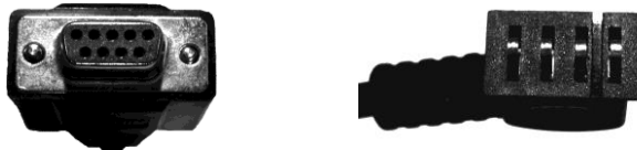
Bild 3: Anschlüsse am Datenkabel für den GPS-Empfänger GEKO 201 links: serieller Stecker für PC, rechts: Stecker für das GEKO 201
